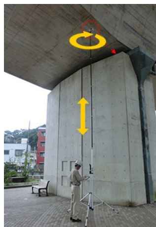
例：「橋梁等構造物の点検ロボットカメラ」【BR010019-V0423】
